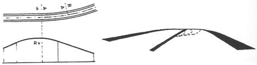
figura 1.106. Início da curva circular após concordância convexa, o que impede ver a mudança de direção em planta
