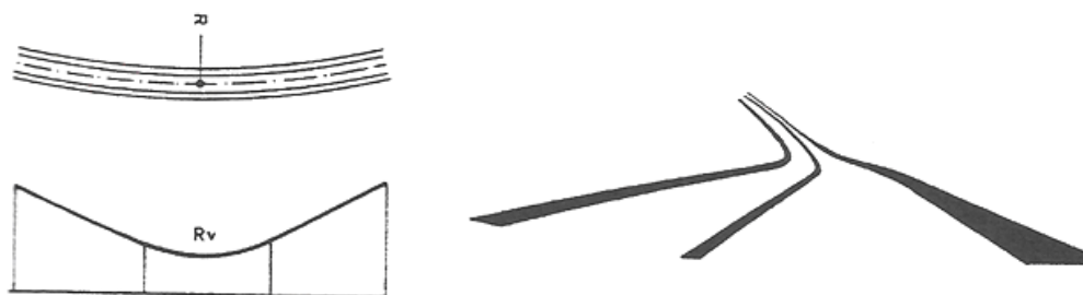
figura 1.108. Curva circular de grande raio e concordância côncava de pequeno raio, provocando quebra do traçado em planta
