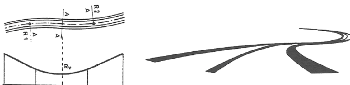
figura 1.110. Concordância côncava entre duas curvas circulares provocando quebra e estreitamento óptico da estrada
