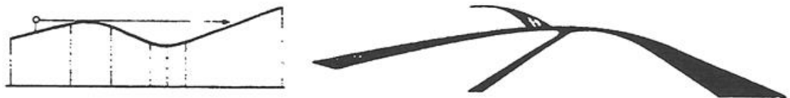
figura 1.105. Mau traçado em perfil (perda do traçado)
