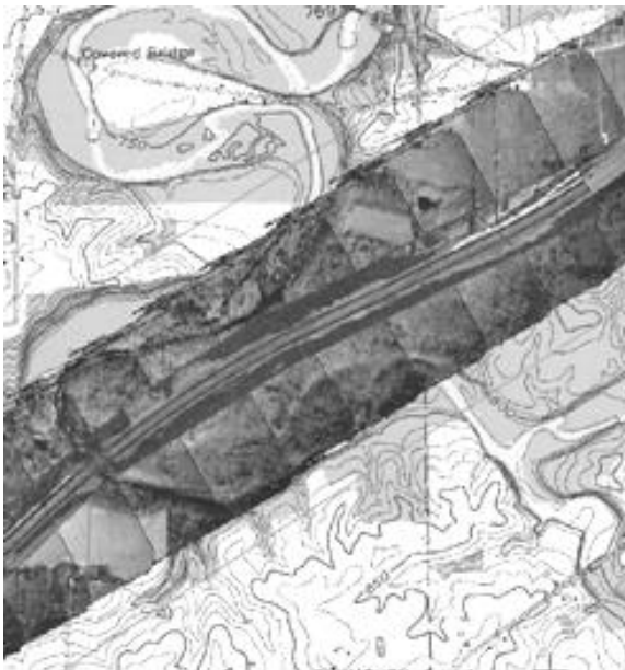
figura 1.10. Cobertura fotográfica para obtenção de cartografia 1/1.000 acompanhando o traçado previsto no estudo prévio
