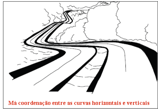
figura 1.100. Coordenação do traçado em planta e em perfil longitudinal
