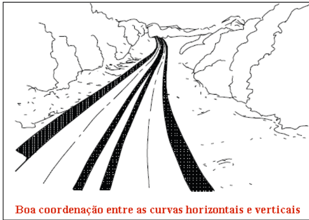
figura 1.100. Coordenação do traçado em planta e em perfil longitudinal
