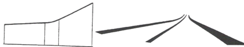
figura 1.102. Mau traçado em perfil (concordância diminuta)
