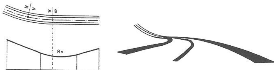
figura 1.109. Concordância côncava após uma curva circular provocando quebra do traçado e estreitamento óptico da estrada
